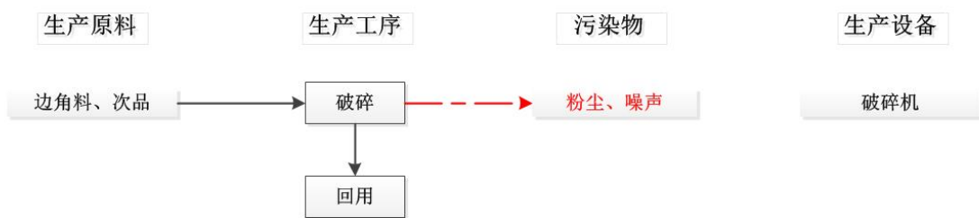
图 2-4 本项目破碎工艺流程及产污环节图
