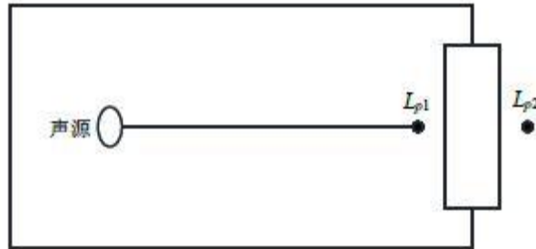
图 4-1 室内声源等效为室外声源图例
