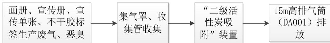
图 4-2 项目有机废气处理工艺流程图
