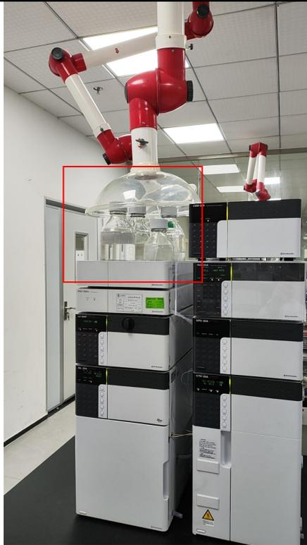
图 4-1 项目万向罩收集示意图
