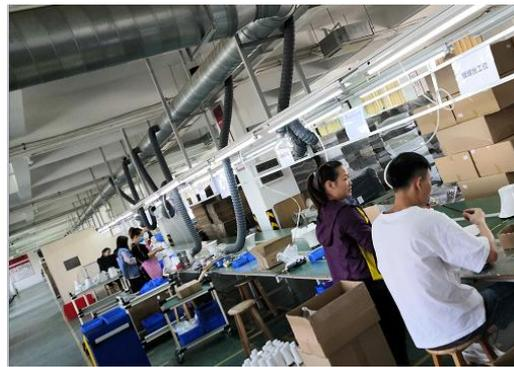
电烙铁焊接生产线集气罩
